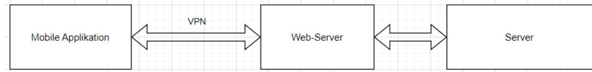
Abbildung 18 Verbindung zwischen der mobilen Applikation und dem Server
