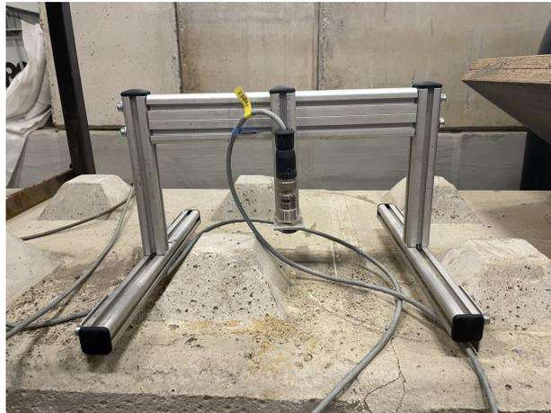
Abbildung 4.2: An einem Gestell befestigter Ultraschallsensor
