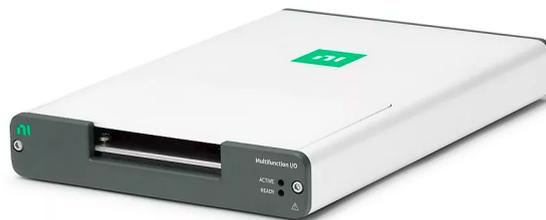
Abbildung 3.4: DAQ-Box von National Instruments
