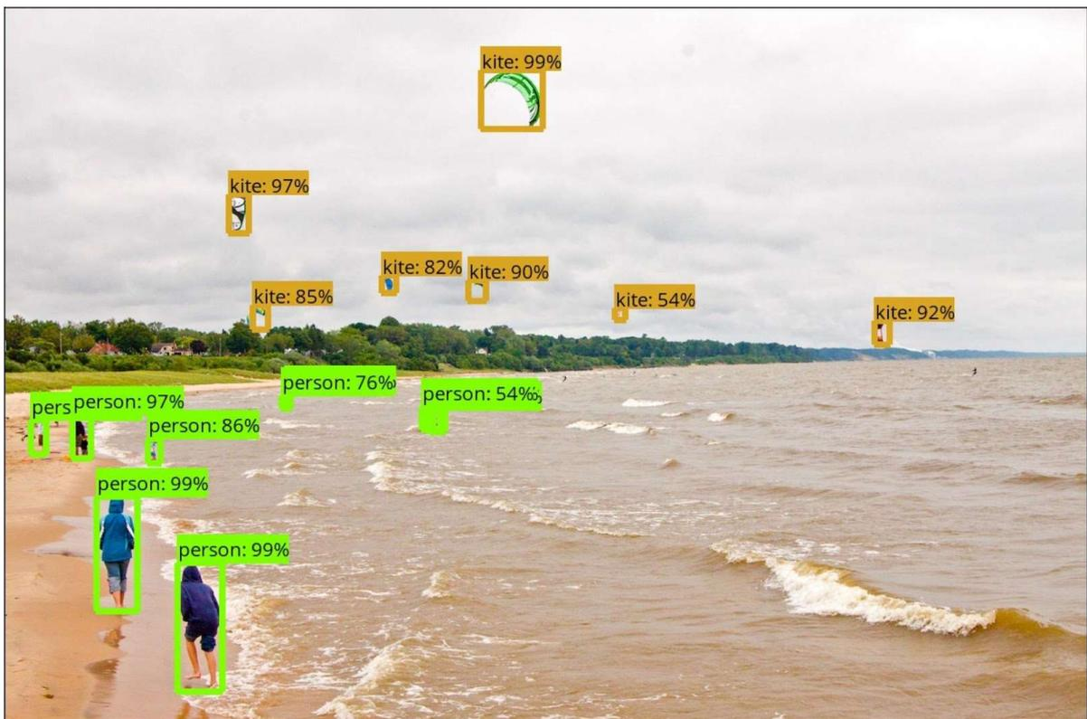
Abbildung 5 Ein trainierter Algorithmus erkennt Objekte und deren Position in einem Bild. Zum Training müssen diese Annotationen erst von Menschen angebracht werden, bevor ein Algorithmus sie erkennen kann.
