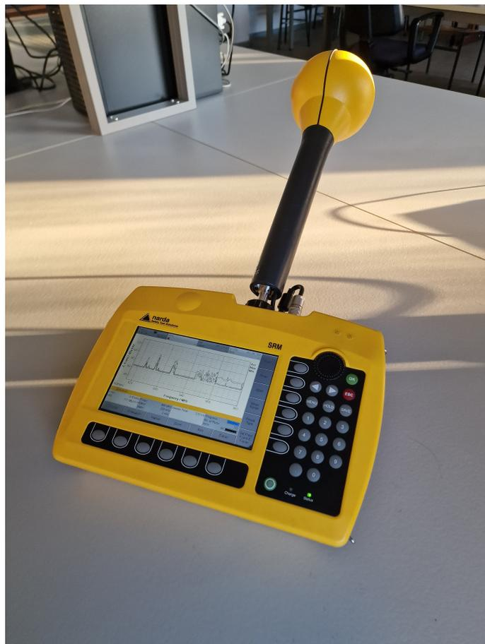
Abb. 2.1: Das Selective Radiation Meter SRM-3006
