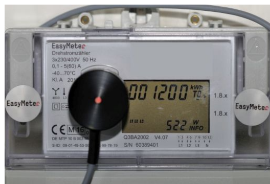
Abbildung 3.1: Beispiel eines Smartmeters mit serieller Schnittstelle [7]
