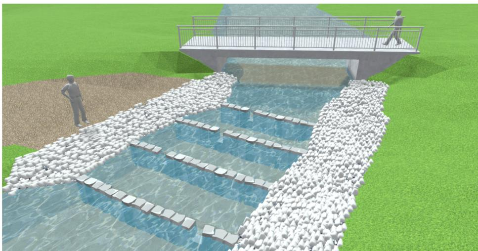
Abbildung 3.3: SketchUp-Modell eines abgeschlossenen Projekts einer beckenartigen FAA am Replener Meer in Moers. Das Modell dient als Beispiel für eine potenzielle virtuelle Umgebung im VR-Szenario.
